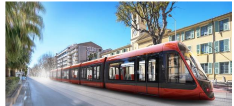
Superkapacitorer og batterier erstatter sammen med lynopladning køreledningerne på størstedelen af en ny letbane, der skal anlægges i Nice. (Illustration: Alstom)
